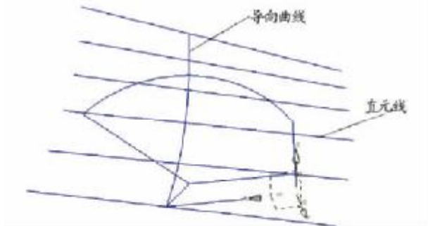
图 2 用于创建犁体曲面的空间线架
