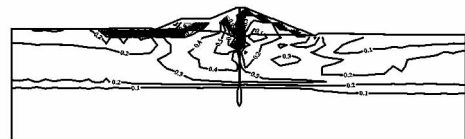
图 11 正常蓄水位时坝体及覆盖层应力水平等值线(单位:MPa)
