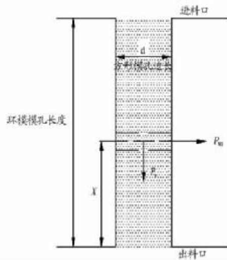
图 3 物料在方形模孔受力计算示意图
