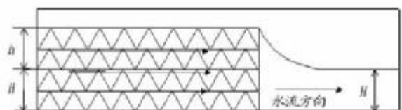
图1 框架完全填充河道过流断面侧视图
