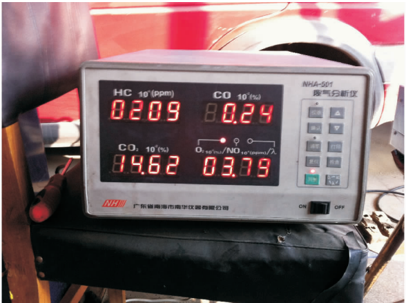
图2 NHA – 501 型废气分析仪
