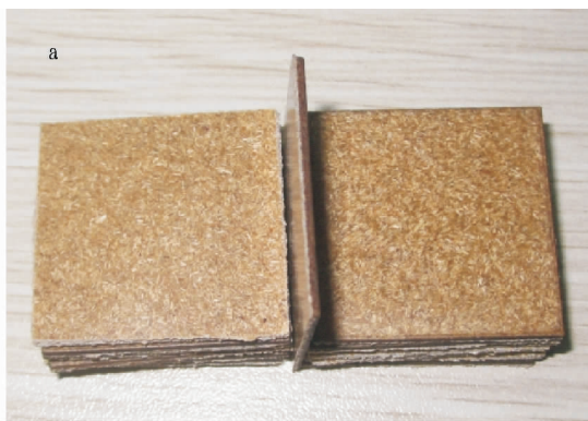
图 2 PP/木粉薄片(a)和 PE/木粉薄片(b)
