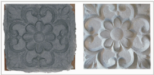
图 4 废纸浆原料压花法试验
