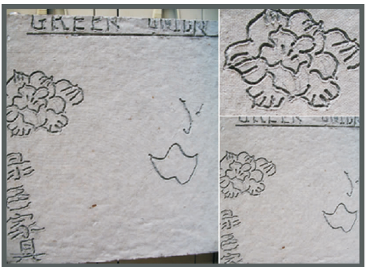
图 5 废纸浆原料雕刻法试验
