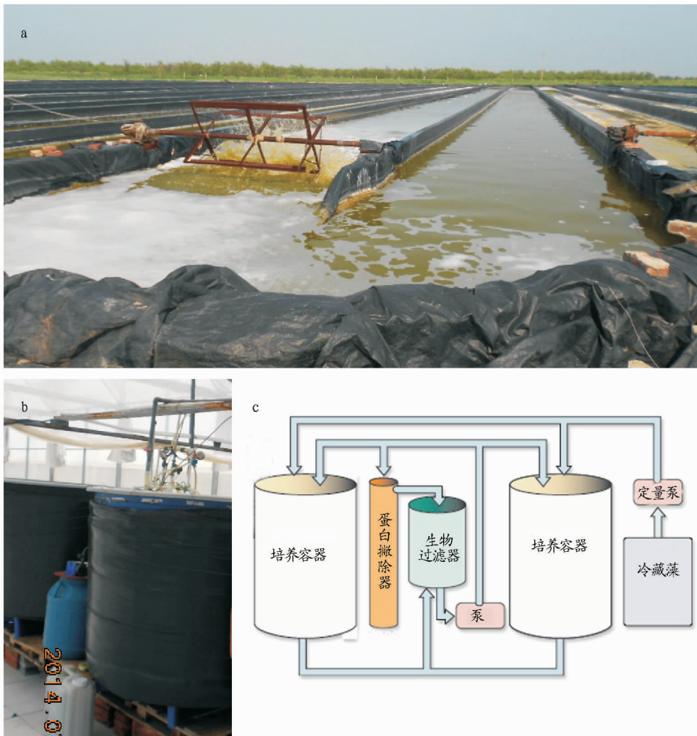
注:a. 跑道式单胞藻培养池;b. 轮虫高密度培养系统;c. 轮虫高密度培养设备示意 [6] 。
