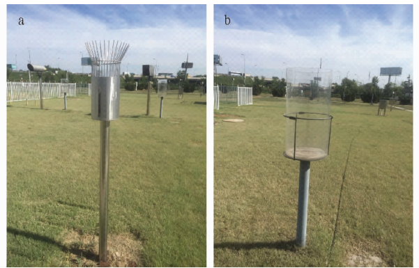
图1 称重法集尘缸(a)和电镜法集尘缸(b)
