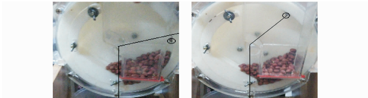
图 5 清种起始角和终止角试验图
