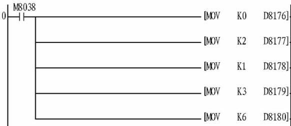
注:M8038 表示 N: N 网络参数设置;D8176 表示站点号设置;D8177 表示从站点总数设置;D8178 表示设置模式范围;D8179 表示重试次数;D8180 表示通信超时设置。
