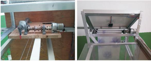
图 3 试验样机局部电机
