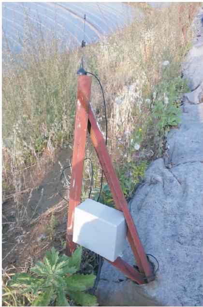
图 6 环境监测传感器节点安装部署
