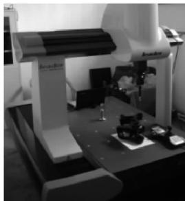
图 3 三坐标测量仪
