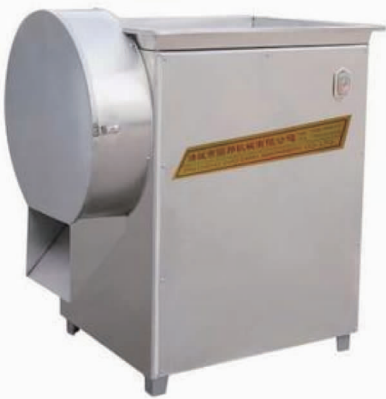
图 3 马铃薯切片机 Fig.3 Potato slicer
