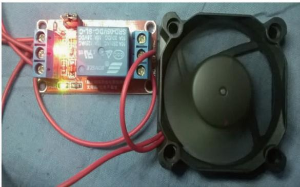
图13 继电器控制风扇实物结果
