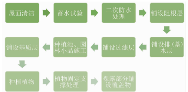
图1 屋顶绿化施工流程
