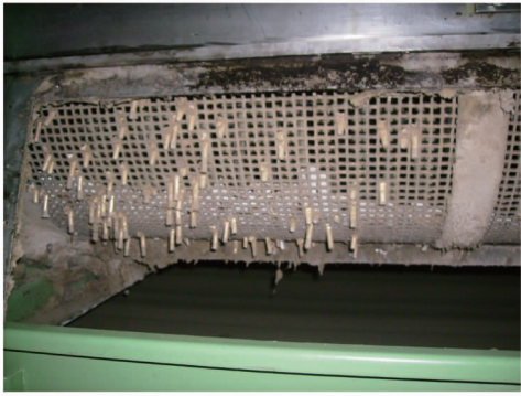
图 2 离心分离装置框栏生产实物图 Fig.2 The frame production of the centrifugal separation device
