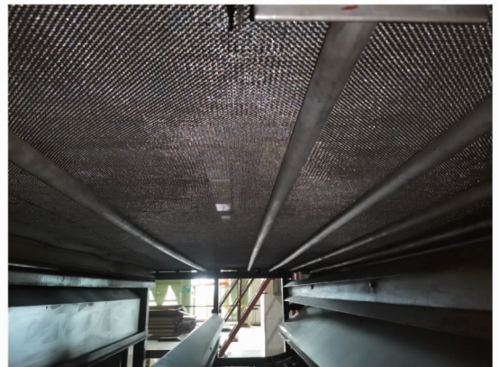
图 2 安装好的编制输送网带
