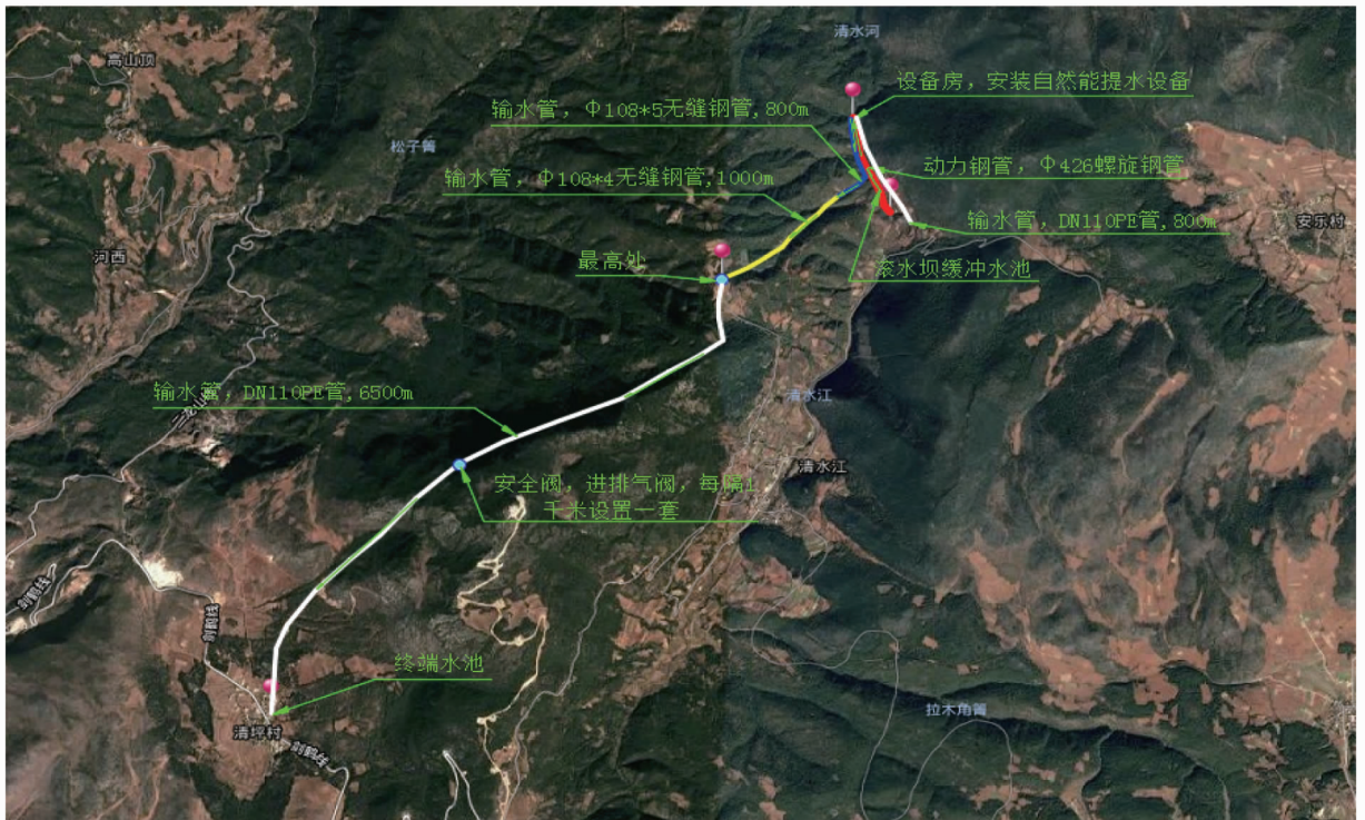
图2 清坪村自然能提水工程建设示意(俯视)
