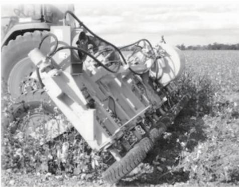
图3 对辊式棉秆拔秆机
