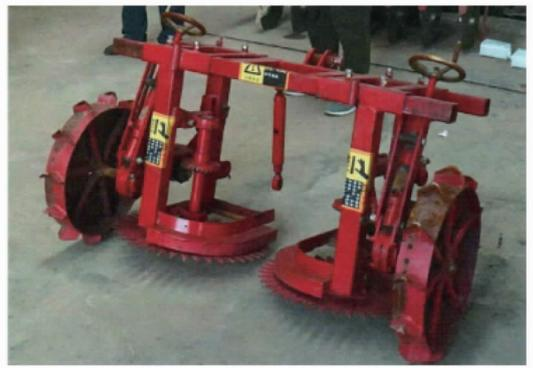
图4 齿盘式棉秆拔秆机
