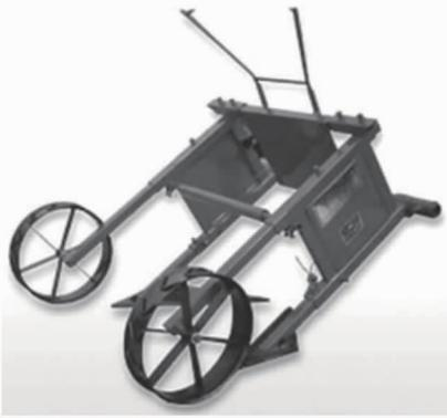
图1 铲切式棉秆拔秆机
