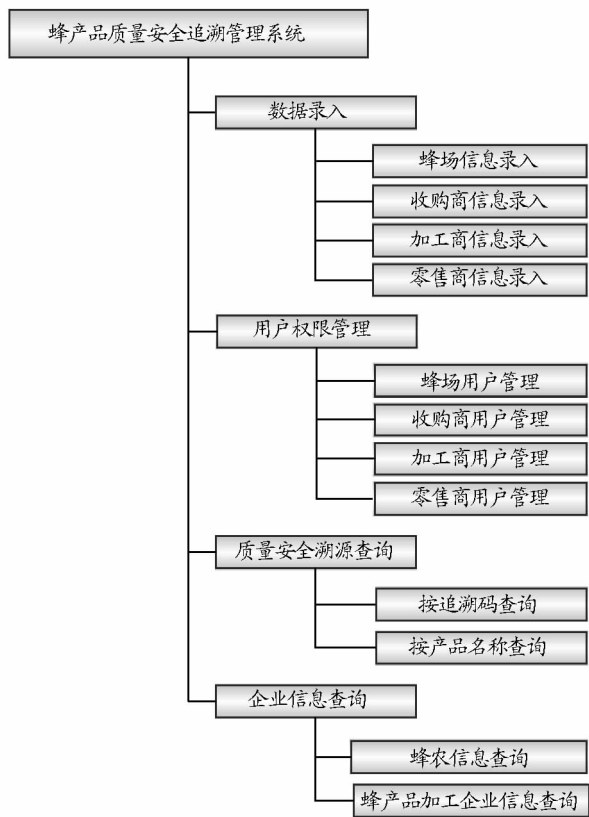
图3 蜂产品质量安全追溯管理系统总体功能模块设计结构
