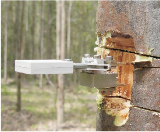
图1 采用 HBM DD1 应变传感器测定仪测定轴向生长应变值
