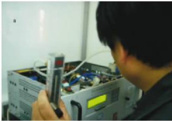
图 2 2008 年 11 月 3 日测试(a)和更换(b)采样泵
