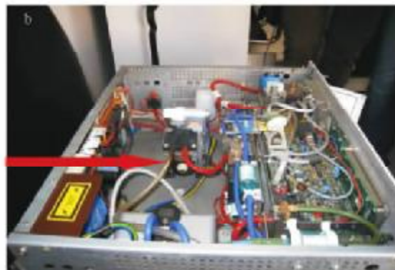
图4 除湿管路与采样管连接胶管故障(a)和除湿泵连接胶管故障(b)
