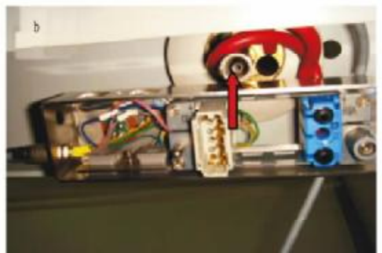
图 3 升降杆接触簧片故障(a)和采样管接口磨损故障(b)
